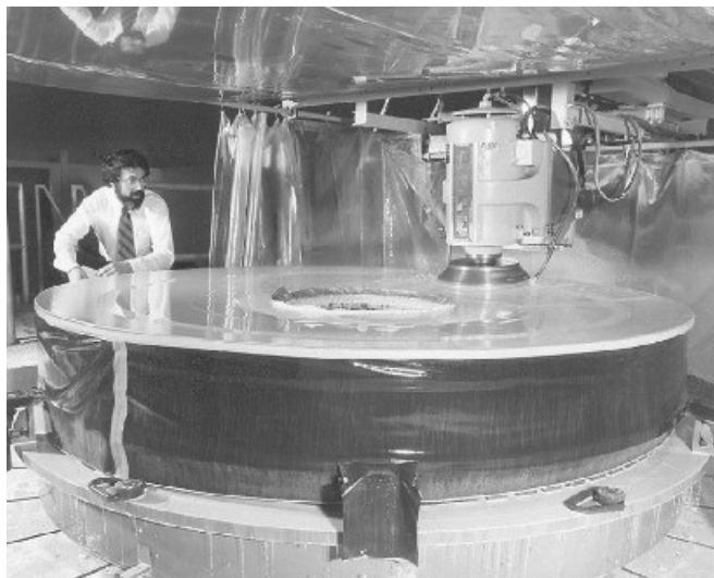
Espejo principal del Hubble cuando se estaba fabricando. «Puedo verme puliendo ese espejo.»
