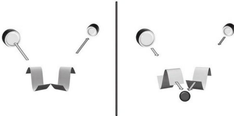
Si la distancia a los espejos es distinta, una de las ondas se retrasa respecto a la otra. Cuando se reencuentran, una cresta coincide con un valle. Las ondas se restan (interferencia destructiva): vemos un punto oscuro.
